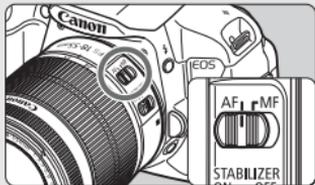
**Set the lens focus mode switch to <AF>** (p.39).
