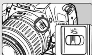
**Set the lens focus mode switch to <AF>.** (p.25)
