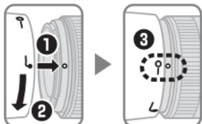
*Alinhe a marca de bloqueio do pára-sol da objectiva (—○) com a marca de montagem do pára-sol da objectiva (●) na objectiva (③).*
