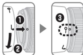
将镜头遮光罩锁定标记(—○)与镜头上的镜头遮光罩安装标记(●)对齐(③)。
