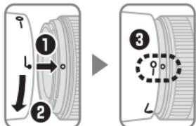
Zarovnajte značku aretovanej polohy slnečnej clony objektívu (—○) s upevňovacou značkou slnečnej clony objektívu (●) na objektíve (3).
