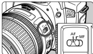
**1 On the lens, set the focus mode switch to <AF>.**
