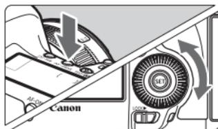
1 Press the  $\langle \text{AF} \cdot \text{DRIVE} \rangle$  button. (  $\odot 6$  )
