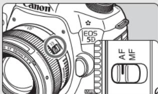
**Set the lens focus mode switch to <AF>** (p.39).
